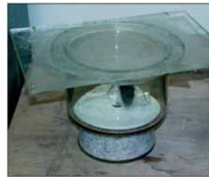
Figuur 4 Verschillende stadia in de zuurproef voor bepaling van het vezelvolumegehalte van koolstofvezelversterkte laminaten
