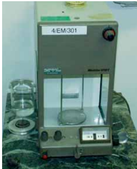
Figuur 3 Analytische balans voor dompelproeven
