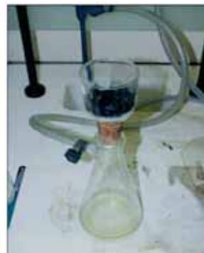
Figuur 4 Verschillende stadia in de zuurproef voor bepaling van het vezelvolumegehalte van koolstofvezelversterkte laminaten
